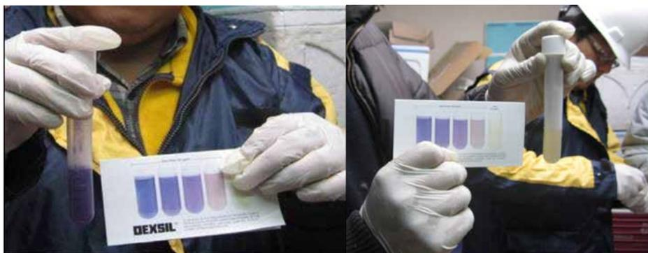
**Figura 3.** Resultados de las pruebas del kit colorimétrico; la vista del lado izquierdo, con resultado de color lila, representa aquellas muestras libres de PCBs y la vista del lado derecho del resultado de color crema amarillento, representa muestras con PCBs.
