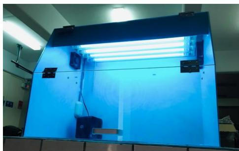
**Figura 1.** Cámara real de reacción. Fuente Propia. Muestra del diseño real estructurado para las experimentaciones acoplado de un sistema de lámparas UV-A, Actinic BL TL-D 18W/10 1SL/25, marca PHILIPS.
